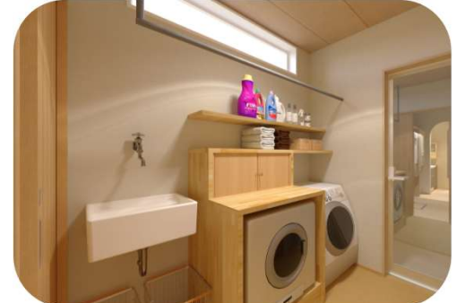
●脱衣・ランドリールーム 家事動線を考慮してスロップシンク・乾太くん洗濯機を横一列に配置しています。天井からはランドリーパイプも設置していますのでコンパクトで使い易い「家事ラク」設計となっています。
