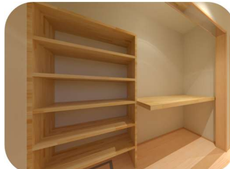
●収納 奥行きのあるカウンターは寝具の収納スペースとして、棚には本や小物をスッキリ収白地納可能となっています。可動式のため、収納物のサイズに合わせて棚の高さを自由に変えられます。
